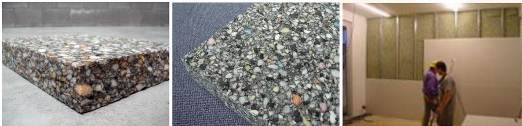
Le panneau VB est une mousse à base des flocons de mousse recyclée absorbant le bruit et anti-vibratoire. Il est un produit recyclé sur la base d'une mousse de polyuréthane élastique à cellules ouvertes. Selon l'application la densité peut varier de 80 kg/m<sup>3</sup> à 120 kg/m<sup>3</sup>.
