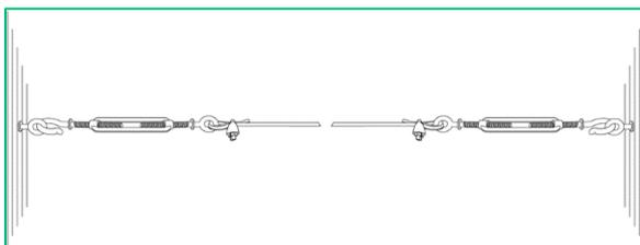
Serrez le tendeur pour limiter l'affaissement du câble à un minimum. Contrôlez la tension du câble après 3-4 jours et corrigez si nécessaire.
